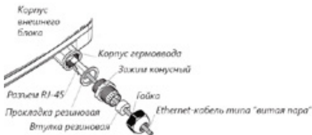
Рис. 2. Подключение Ethernet-кабеля к внешнему блоку
